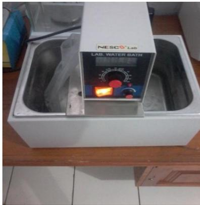
Gambar 3. Pengujian Cooking loss menggunakan water bath
