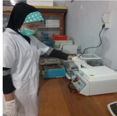
Gambar 2. Pengujian WAC menggunakan sentrifuge
